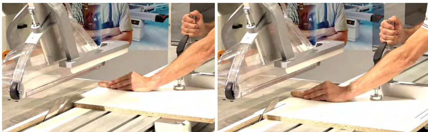
Das Blade off System erkennt mögliche Gefahrensituationen vorzeitig und verhindert sie, indem das Sägeblatt in einem Bruchteil einer Sekunde im Maschinentisch verschwindet.
